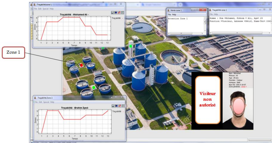
Figure N° 10. (a) Traçabilité, (b) Informations de la personne, (c) alerte sonore accompagnée d'un message indiquant le numéro de la zone qui est en risque.
