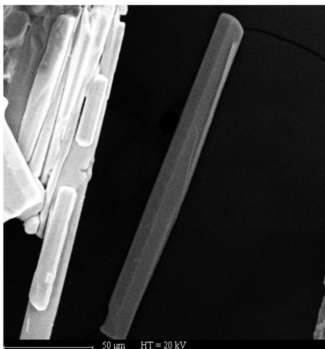
Figure IV.1 : photographie des monocristaux de \text{NH}_4[\text{HgCl}_2(\text{SCN})] (MEB x500)
