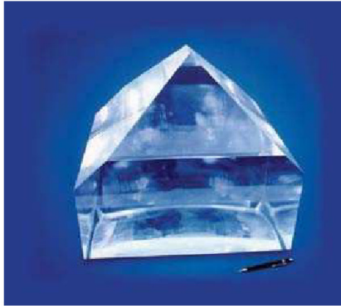
Figure I-3 : monocristal de KDP ( \text{KH}_2\text{PO}_4 ).
