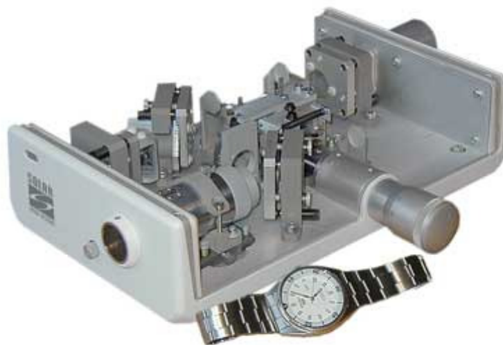
Figure 3 : OPO basé sur un cristal de \beta – BaB 2 O 4 et pompé par un laser Nd:YAG
