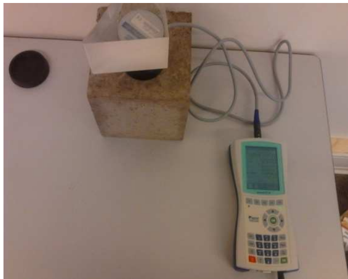
Figure. II.11 : Dispositif de mesure des propriétés thermophysiques (ISOMET 2114).
