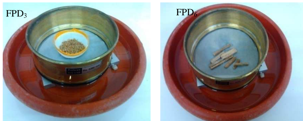
Figure. II.7: Dispositif de saturation des fibres de bois de palmier dattier FPD 3 , FPD 6
