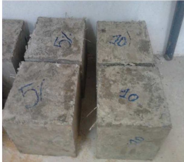
Figure. II.10 : Echantillons après démoulage.
