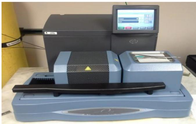
**Figure II. 9.** Appareil ATG/DTG (TA Q600)
