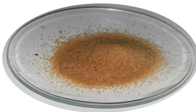
Figure II. 2. Résine de PGMA-g-PVC/HDA
