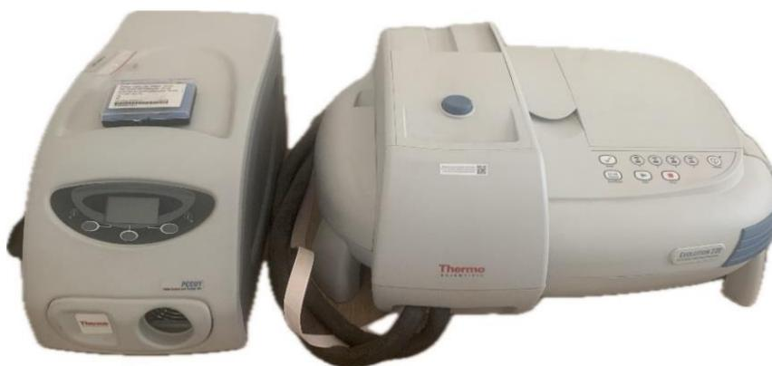
Figure II. 5. Spectrophotomètre UV-Visible (Thermo Fisher Evolution 220)
