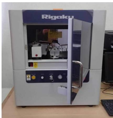
Figure II. 7. Diffractomètre (DRX) Rigaku MiniFlex 600
