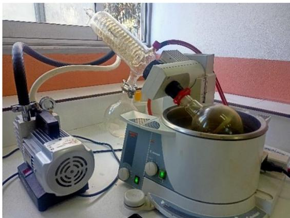
Figure 48. Evaporateur rotatif.
