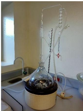
**Figure 49.** Dispositif d'hydro-distillation
